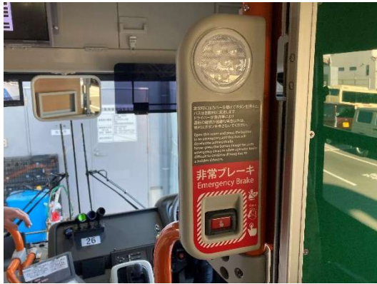
ドライバー異常時対応システム(EDSS) 新造乗合車5両に全車装備
